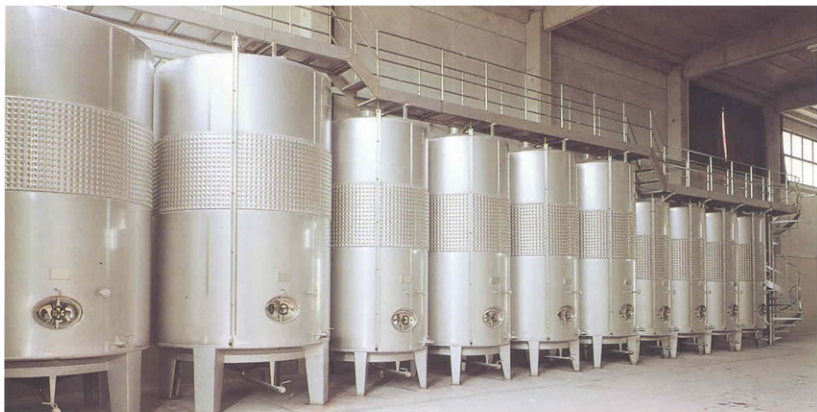
■ Gruppo di serbatoi a fondo conico refrigerati.
